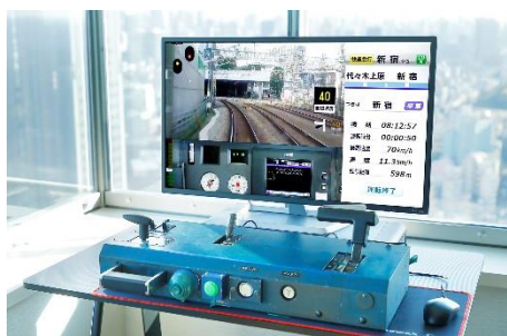
特急ロマンスカー・EXE（30000 形）で 使用していた運転台機器（マスコンハンドル）を 握りながら楽しむ小田急線の本格運転シミュレータ
